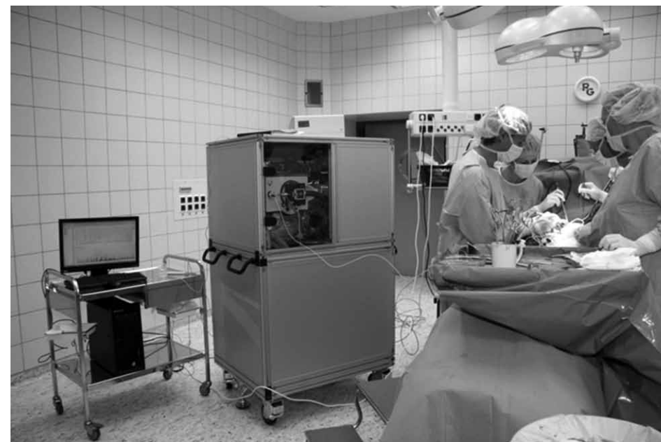
2. ábra • Az intelligens sebészeti eszköz használata műtét közben, a Debreceni Egyetem Sebészeti Intézetében. A tömegspektrométer (középen) – az összes szükséges kiegészítőjével együtt – a műtéti követelményeknek megfelelő zajszigetelő, kerekeken gurítható szekrénybe van zárva. Az adatgyűjtéshez és -feldolgozáshoz szükséges számítógépes rendszer is (balra) mozgatható asztalon nyert elhelyezést.
