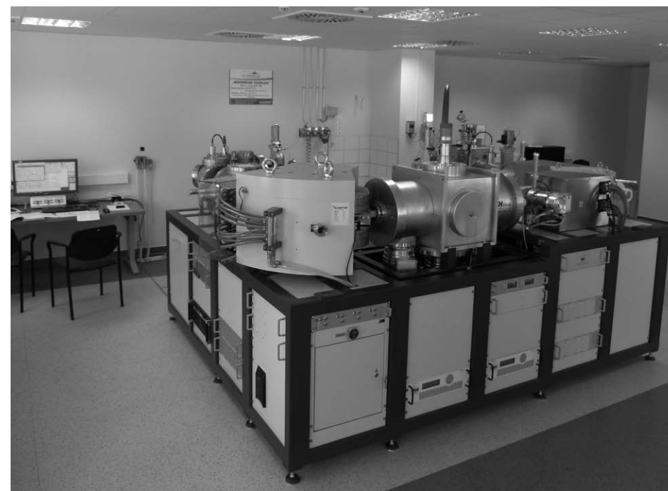
7. ábra • EnvironMICADAS gyorsító tömegspektrométer ^{14}\text{C} -mérésekre a Hertelendi Környezetanalitikai Laboratóriumban, MTA ATOMKI – Isotopech Zrt., Debrecen
