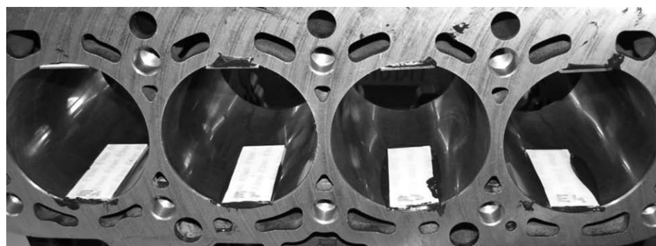
1. ábra • Szilikonlenyomat készítése a hengerfelületről
