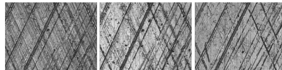
5. ábra • A spirálhónolt hengerfelület kiindulási, 40 és 140 órás kopott állapotáról készített lenyomat képe
