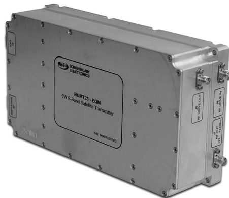
9. kép • A megszerelt mérnöki kvalifikációs (EQM) példány
