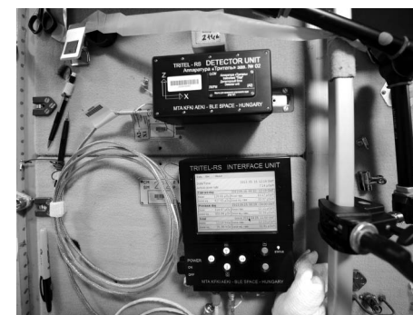
9. kép • A TRITEL RS detektora és központi egysége az ISS Zvezda moduljában
