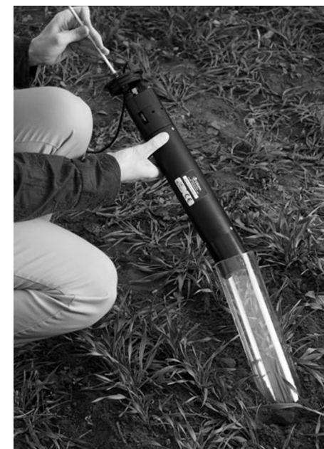
1. kép • A CI-600 típusú gyökérszkennert és a talajba helyezett mérőtubus
