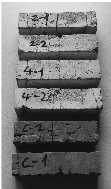
6. ábra • A habarcsasabok törésük után (a két alsó kiégetetlen márgából készült)
