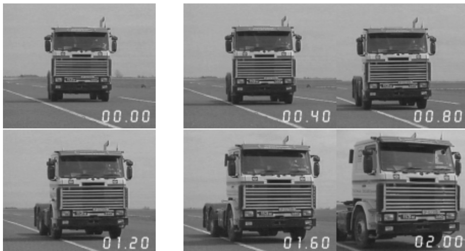
5. a (fent) és b (lent) ábrák • Sávelhagyás megelőzése tesztjárművel, nem jelzett útpályahatár esetén
